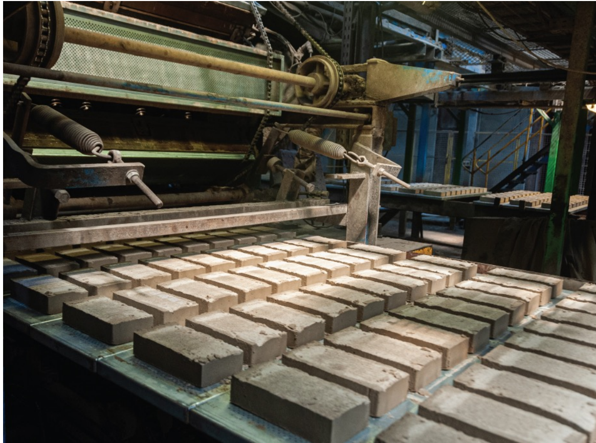
Vormsteenproductie bij steenfabrikant BrickZ, Vande Moortel Foto: © BrickZ
