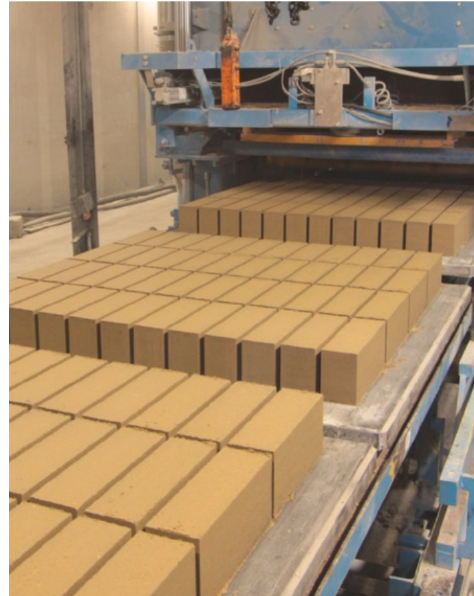
Leemsteenproductie door vibrocompactie bij betonsteenfabrikant Claesen Foto: © BC Materials
