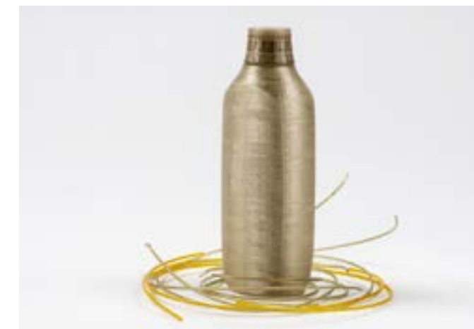
3D printing van bioplastic gemaakt uit micro-algen
